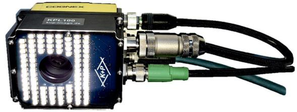
Durch die große Anzahl von LEDs und die Möglichkeit sehr kurzer Pulszeiten kann eine nahezu vollständige Unabhängigkeit von Fremdlichteinfüssen sichergestellt werden. Die Montage der Lampe direkt vor das Objektiv schützt dieses zudem vor Staub und Schmutz. Das vor den LEDs befindliche Acryglasfenster ist auswechselbar, sodass im Falle von dessen Verschmutzung oder Beschädigung die ursprüngliche Bildqualität wiederhergestellt werden kann.
